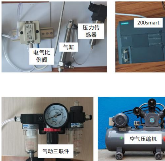
图8 电器比例阀气压伺服系统半实物测量平台
